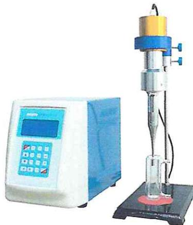
Figure 5 : Sonicateur (Fisherbrand™ Sonicateur 505 avec sonde)
