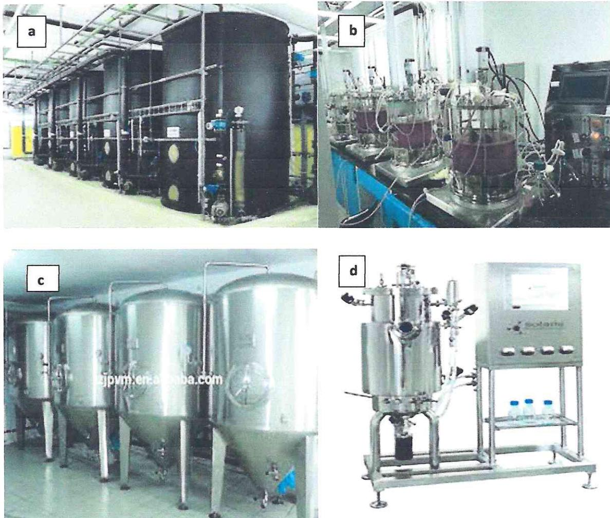
Figure 4 : Les différents bioréacteurs (a, c : Bioréacteurs Industriels ; b et d : Bioréacteurs de laboratoires)
